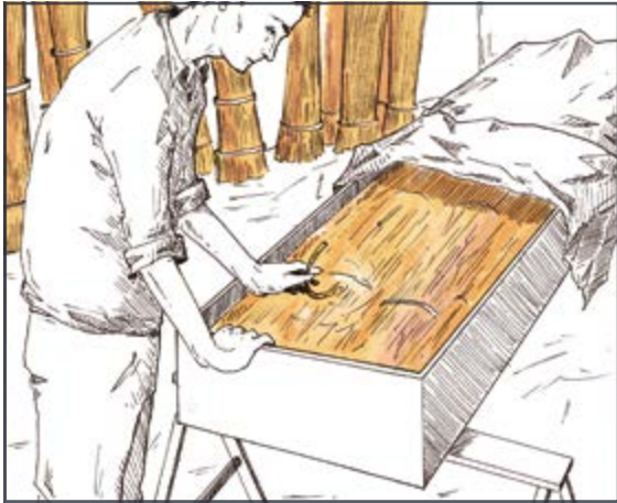
LES BRINS D'OSIER ÉCORCÉ SONT TREMPÉS DANS UN BAIN D'EAU FROIDE AFIN DE LES ASSOULIR.
